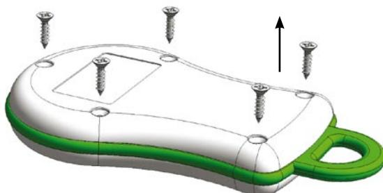
Lösen Sie die 5 Schrauben des Gehäuses.
