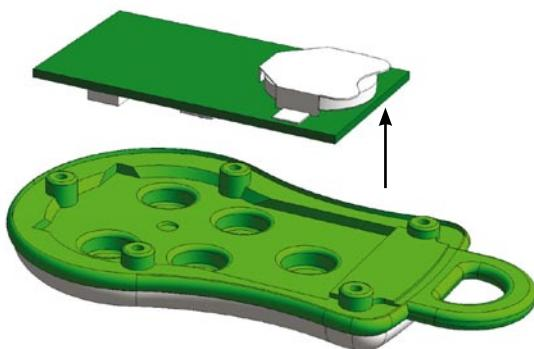
Retire a placa electrónica do respectivo compartimento.
