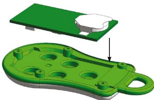
Sostituire la scheda elettronica nel suo alloggiamento.
