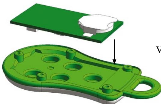
Volte a colocar a placa electrónica no respectivo compartimento.
