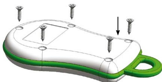
Volte a colocar a cobertura e aperte os 5 parafusos.
