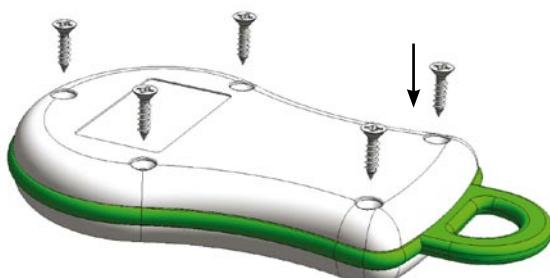
Setzen Sie das Gehäuse wieder zusammen und ziehen Sie die 5 Schrauben fest.
