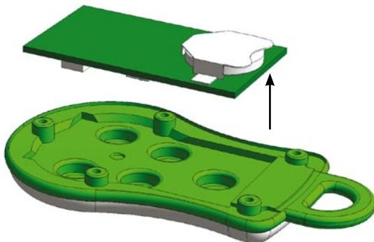
Extraiga la tarjeta electrónica de su emplazamiento.
