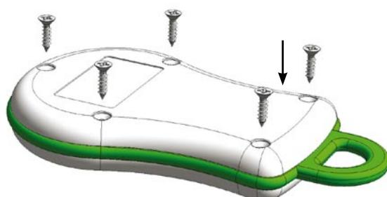
Coloque la tapa del cajetín y atornille los 5 tornillos.
